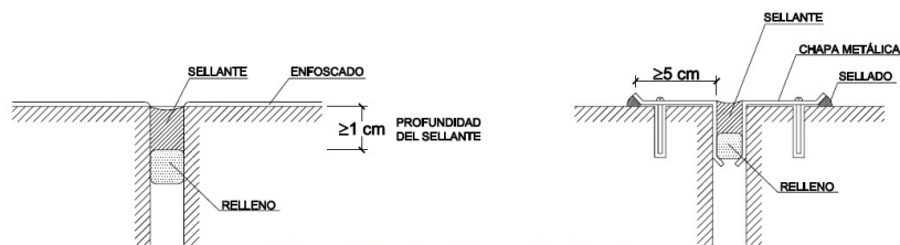
Figura 2.6 Ejemplos de juntas de dilatación
